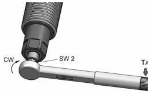
Figura 4 - ATUAÇÃO DO TORQUE NO SEXTAVADO INTERNO
